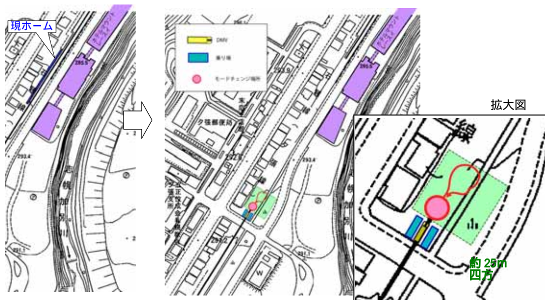
図 2-8 夕張駅でのDMV発着および方向転換方法案
