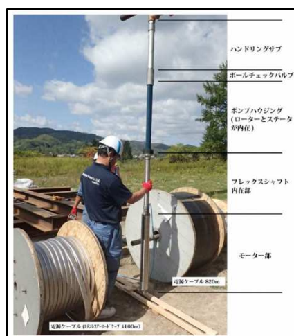
図 4-18 CBM ポンプの概観と各部位の名称
